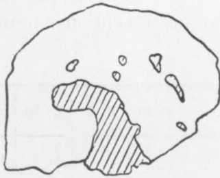
FIG. 12. — Inclusions de galène argentifère dans la pyrite. \times 330 .
