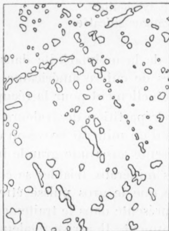
FIG. 15. — Inclusions de chalcopyrite dans la blende. \times 270 .
